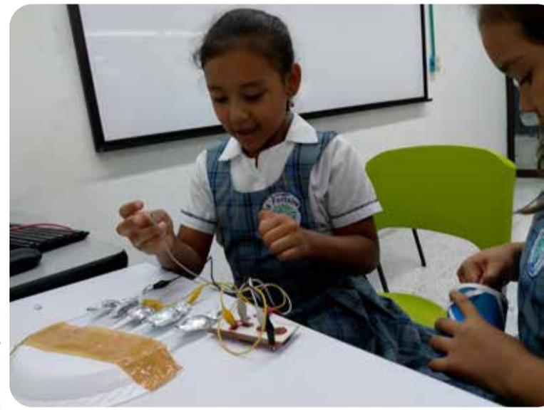
Makey-Makey es una placa con una distribución de "botones" similar al mando de una videoconsola y que puede funcionar en sustitución de un teclado o ratón, lo que permite enviar órdenes al ordenador al que se encuentre conectado.
